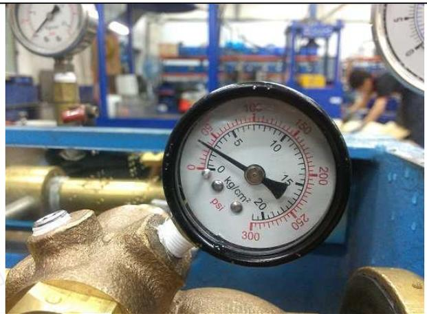
照片 F：功能檢查 (壓力調整閥 2.5 kg/cm<sup>2</sup>)
